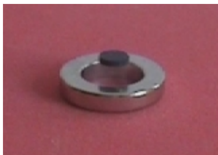
Abb.4: Schwebender Supraleiter über einem Ringmagneten
