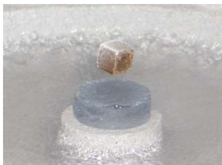
Abb.5: Schwebender Magnet über einem gekühlten Supraleiter
