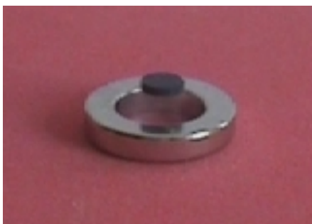
Abb.4: Schwebender Supraleiter über einem Ringmagneten
