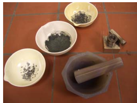
Abb.1: Das Pulver wird mit einem Achatmörser zermalen
