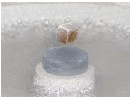
Abb.5: Schwebender Magnet über einem gekühlten Supraleiter
